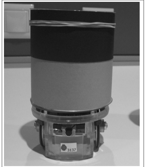
Şekil 2. Renkli başlık ile e-puck robot. Robotların birbirlerini görebilmeleri için geliştirilen renkli başlık robotların üzerine yerleştirilmiştir. Renkli başlığın yan yüzü yeşil renk karton ile kaplanmıştır. Robotlar bu renkli yüzeyin görüntü üzerindeki büyüklüğünden birbirleri aralarındaki mesafeyi ve görece pozisyonlarını hesaplayabilmektedir.
