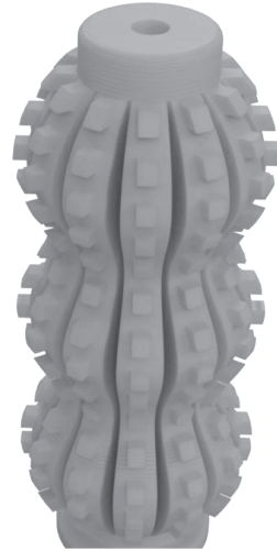
Şekil 5. Çoklu Serbestlik Dereceli Pnömatik Rehabilitasyon Ortezi
