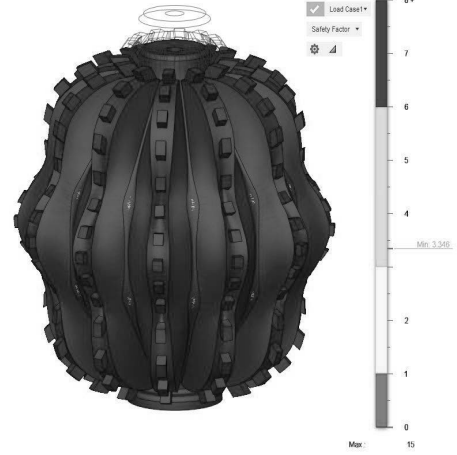
Şekil 16. 1mm Et Kalınlığına Sahip 12 Kanatçıklı Modelin Güvenlik Faktörü Analizi
