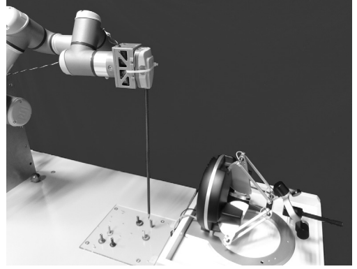
Şekil 7: Fiziksel deney ortamı: 9 serbestlik dereceli cerrahi robot ve 6 serbestlik dereceli haptik cihaz
