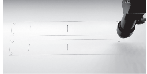
Şekil 6. Lazer kesim tekniği kullanılarak pantograf mekanizmasındaki üst kolu oluşturan Rijit 1 katmanının eklem yerleri ve destek çerçevesi olacak şekilde üretimi.
